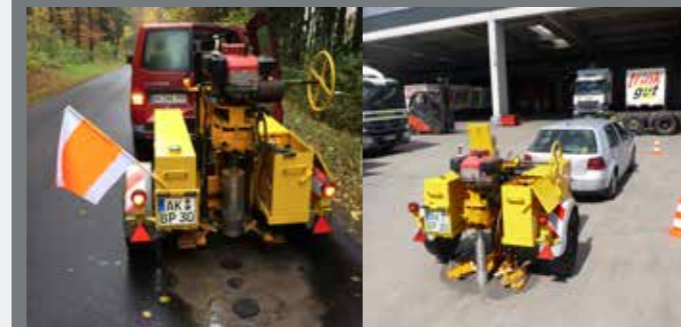
Asphalt- und Betonbohrkernentnahme
