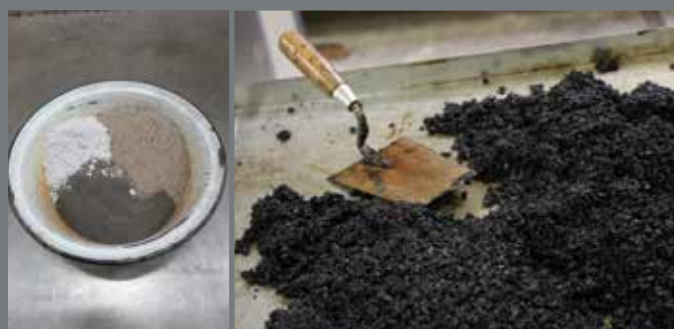
Rezepterstellung und Mischgutherstellung, Asphalt Mischgutuntersuchung
