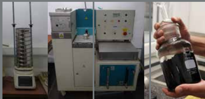
Siebanlage, Extraktionsanlage Asphalt, Extrahierter Asphalt (Bitumen)
