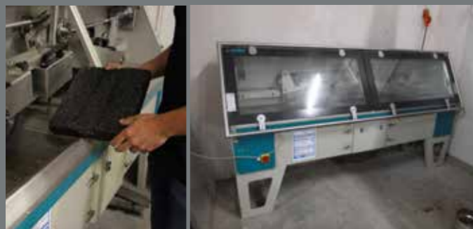
Spurbildungsgerät für die Bestimmung der Spurrillentiefe auf Verkehrsflächen für besondere Beanspruchung (Logistikflächen)
