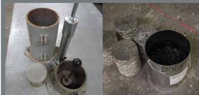
Dichtebestimmung (Proctoroptf), Probekörperherstellung Asphalt- und Betonbohrkernentnahme
