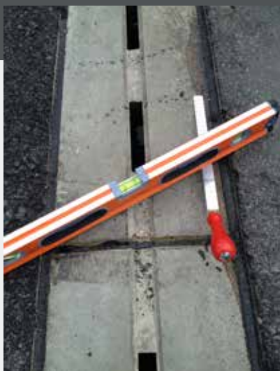
Ebenheitsmessung auf Verkehrsflächen
