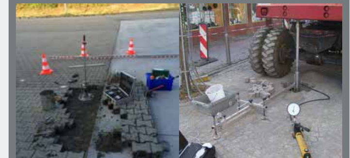
Dynamischer und Statischer Lastplattendruckversuch
