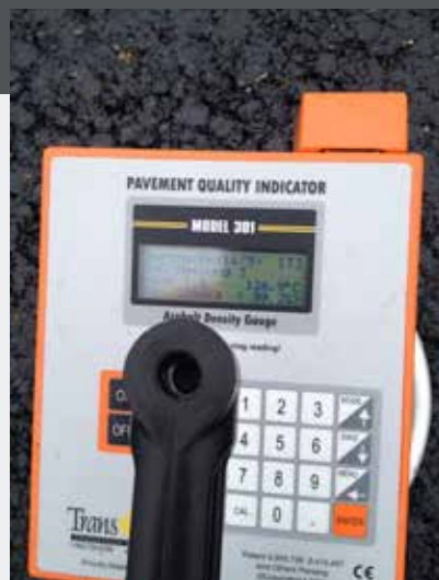
Zerstörungsfreie Verdichtungskontrolle Asphalt
